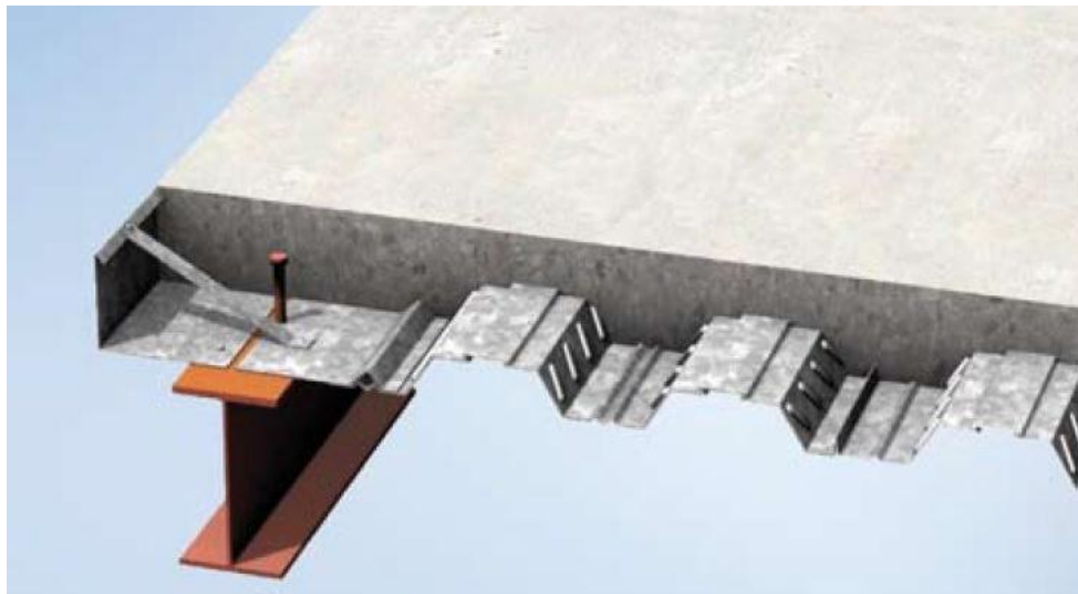
Imagen 27 Chapa colaborante y losa en hormigón.
