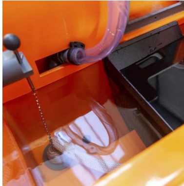
Figura 2. Llenado de almacenamiento superior para medición de caudal.
