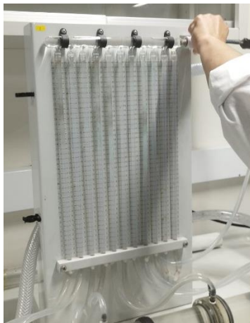
Figura 3. Nivelación de manómetros.
