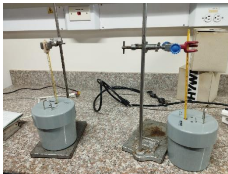
Figura 3. Medición de las temperaturas de los sistemas en los calorímetros.
