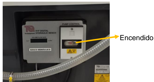
Figura 2. Tablero de control banco hidráulico.
