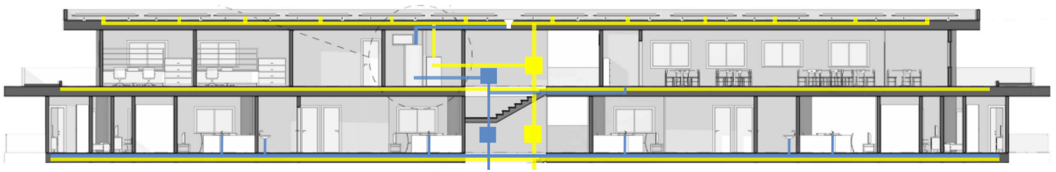
Figura 51 Funcionamiento de sistemas de aguas lluvias y paneles solares
