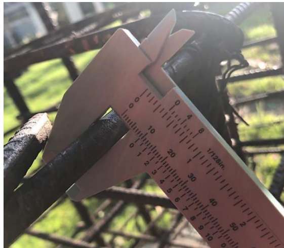
Ilustración 25. Refuerzo transversal (flejes) – medida 2
