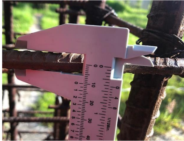
Ilustración 24. Refuerzo transversal (flejes) – medida 1
