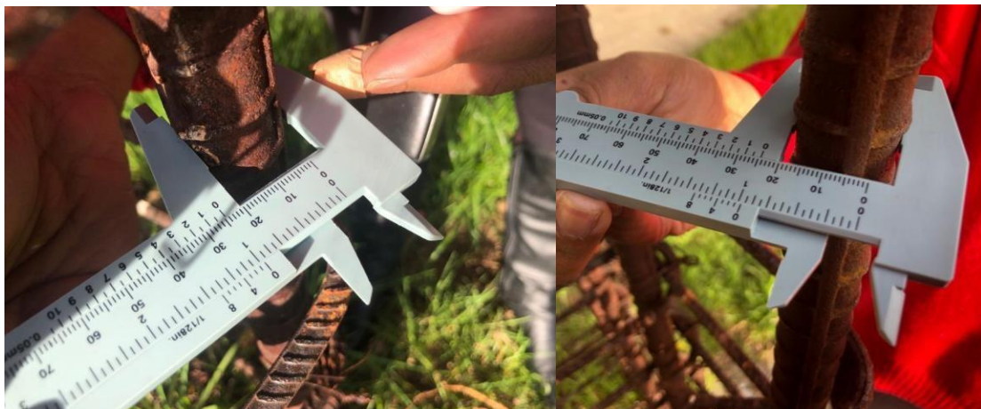
Ilustración 26. Refuerzo longitudinal – medida 1 (izq.) medida 2 (der.)
