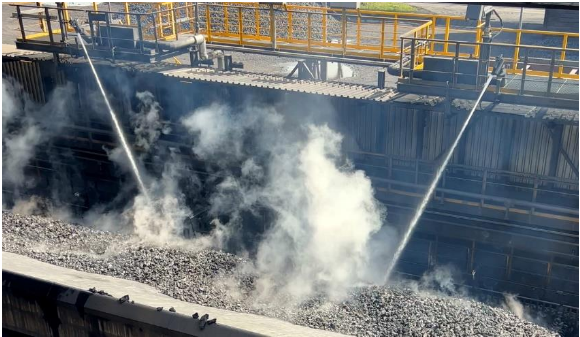
Figura 8. Enfriamiento en húmedo
