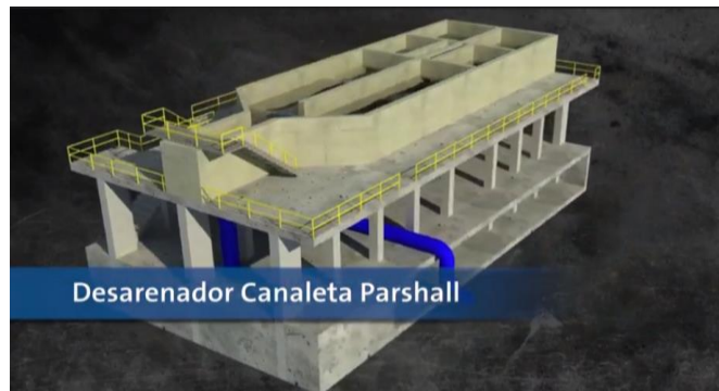
Img.6 Proceso de desarenador en donde se realizará el control y automatización de limpieza superficial. Fuente: Video PTAR de Veolia
