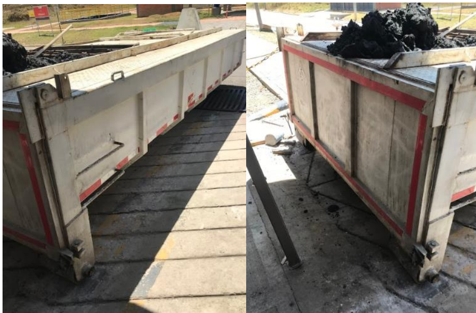
Img.50 Tanque ampliroll en el cual se transporta el lodo deshidratado
