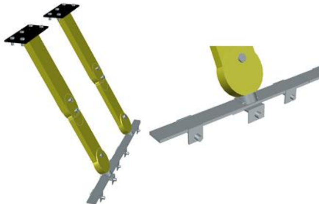
Img.39 Simulación del diseño realizado para la limpieza del canal externo del sedimentador. Fuente: CREACIÓN PROPIA PARA LA PTAR
