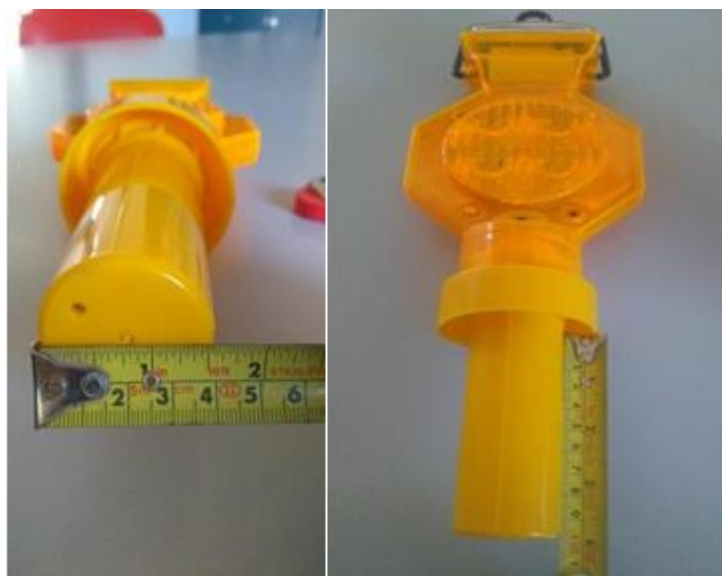
Img. 47 Medidas a tener en cuenta para hacer la base que se sujetarán las lámparas Fuente: Autores
