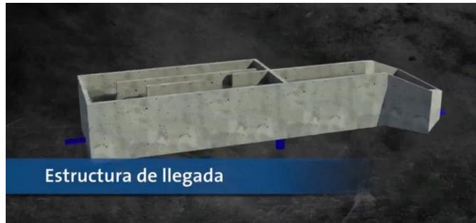
Img. 5 Estructura de entrada Fuente: Video PTAR de Veolia
