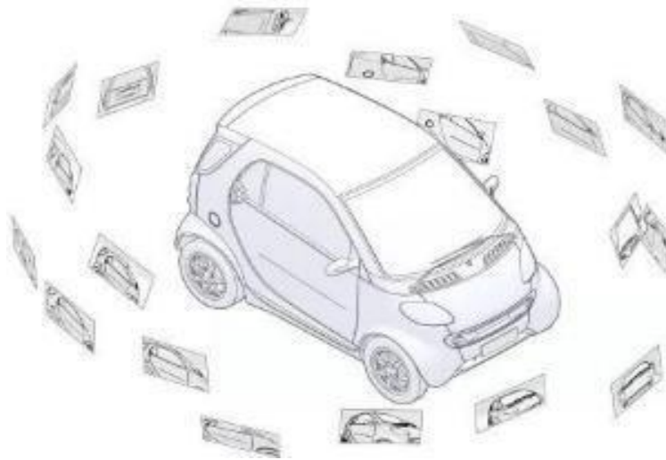
Figura 13. Múltiples imágenes superpuestas tomadas desde diferentes posiciones y ángulos.
