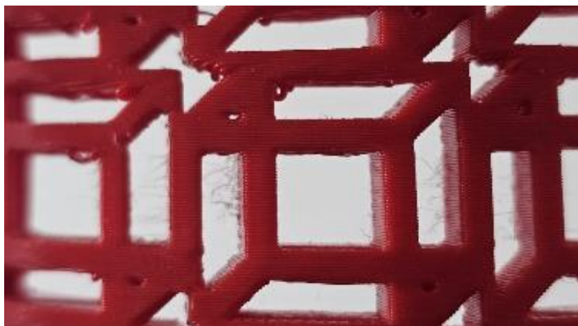
Figura 96. Filamentos sobrantes en voladizos.
