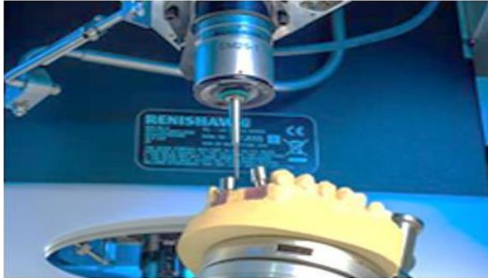
Figura 9. Escaneo de mandíbula mediante sonda de contacto.
