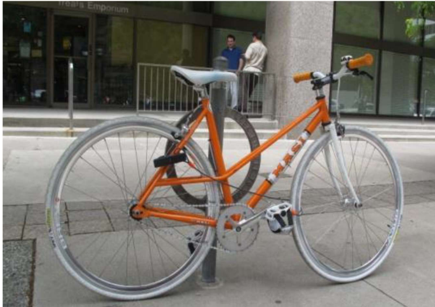
Imagen 8 Estacionamiento bicicletas tipo círculo empotrado al suelo.
