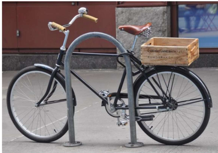
Imagen 7 Cicloparqueadero Tipo 4 - U-invertida empotrado al suelo.
