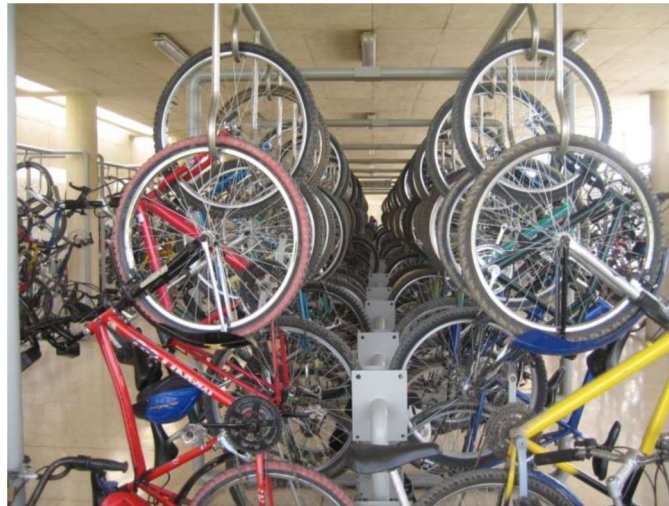
Imagen 6 Cicloparqueadero Tipo Gancho utilizado en espacio cerrado (Estacionamientos de Transmilenio).
