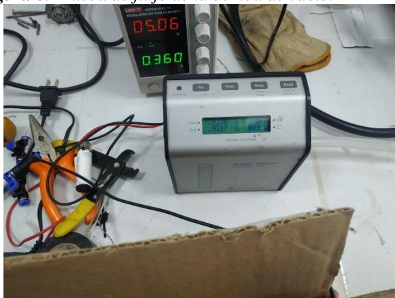
Figura 8. Prueba de flujo de la bomba de vacío.
