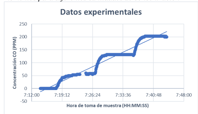
Figura 25. Datos tomados del sensor en distintos momentos para diferentes cantidades de concentración
