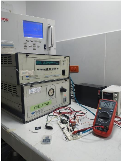
Figura 27. Prueba de funcionamiento para el sensor de detección de O 3
