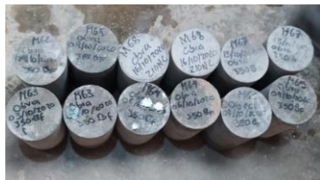
Ilustración 21: Cilindros de concreto elaborados en obra.
