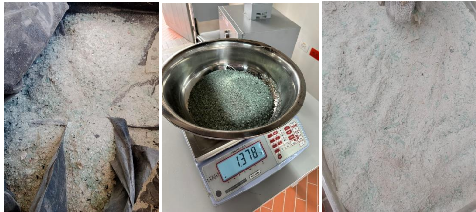
Figura 4. Trituración vidrio templado en la máquina de los ángeles
