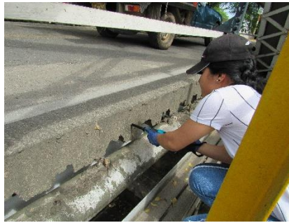
Figura 26. Registro ensayo de esclerometría. – Fuente propia
