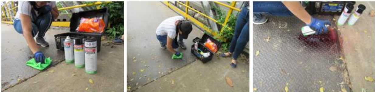
Figura 38. Evidencia ensayo tintas penetrantes.
