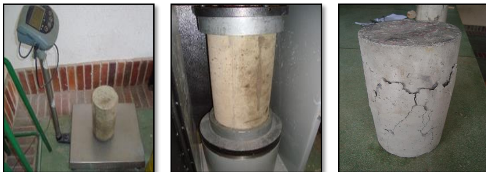
Figura 15. Fallada de cilindros de concreto en laboratorio - cerramiento.
