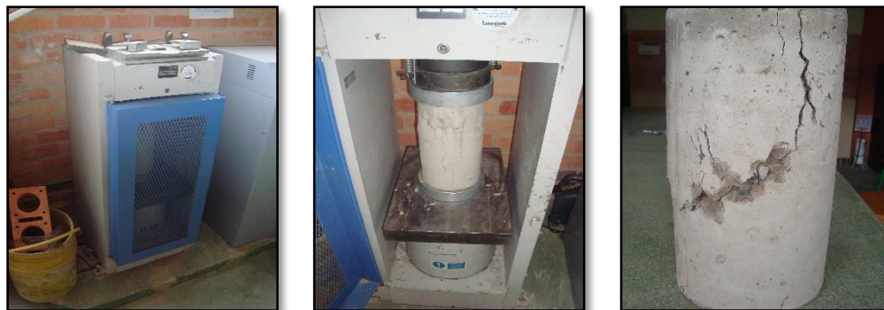
Figura 33. Fallada de cilindros de concreto en laboratorio - andenes.
