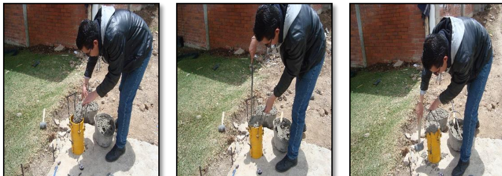
Figura 14. Elaboración de cilindros para muestras de concreto - cerramiento.
