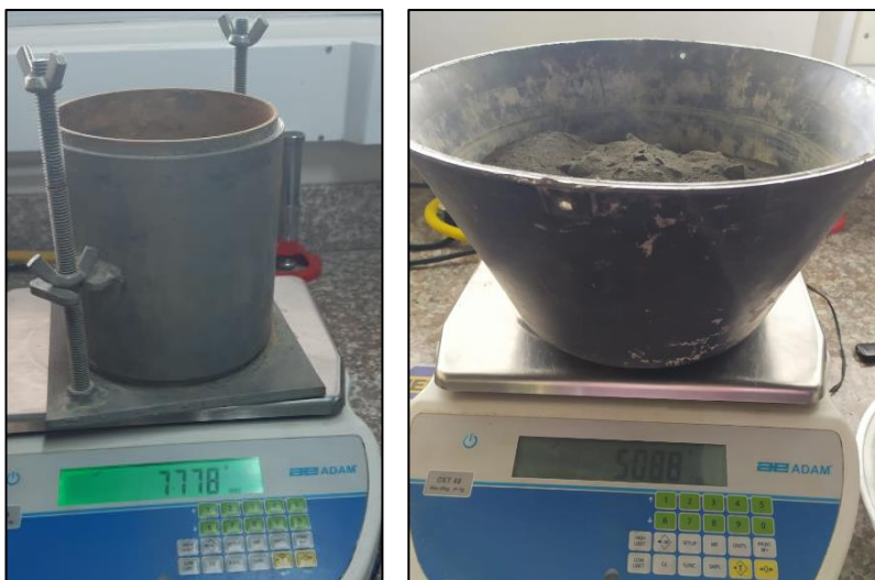
Figura 31. Pesos para el CBR Fuente: Autor.
