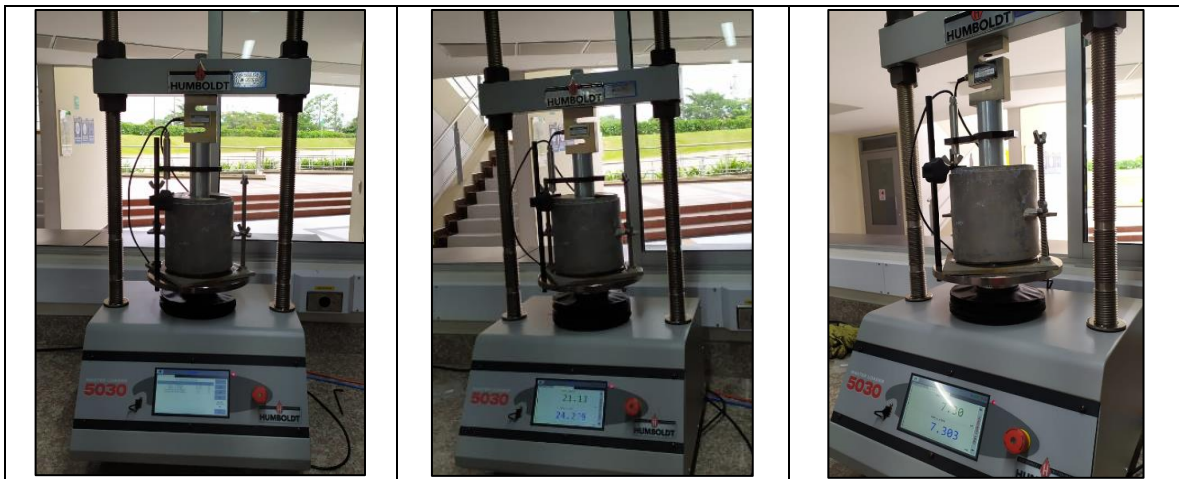
Figura 34. Fallo de CBR en prensa de carga Máster Loader 5030. Fuente: Autor.
