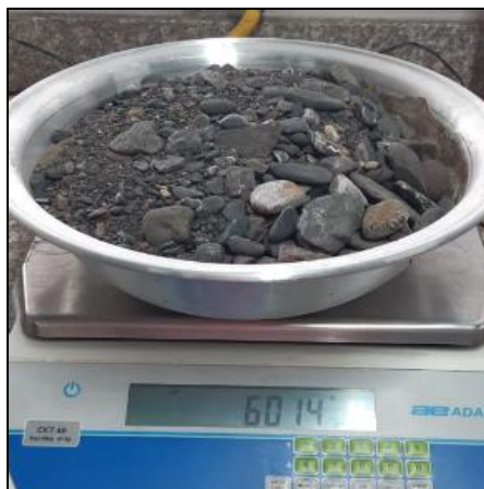
Figura 15. Peso material lavado por tamiz No 200. Fuente: Autor.
