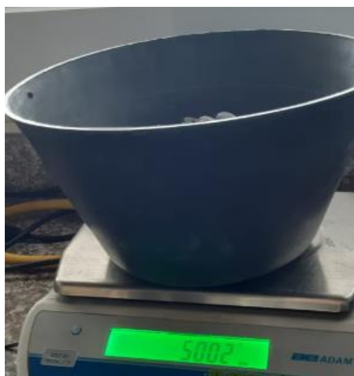
Figura 21. Peso antes del desgaste en la máquina de los ángeles
