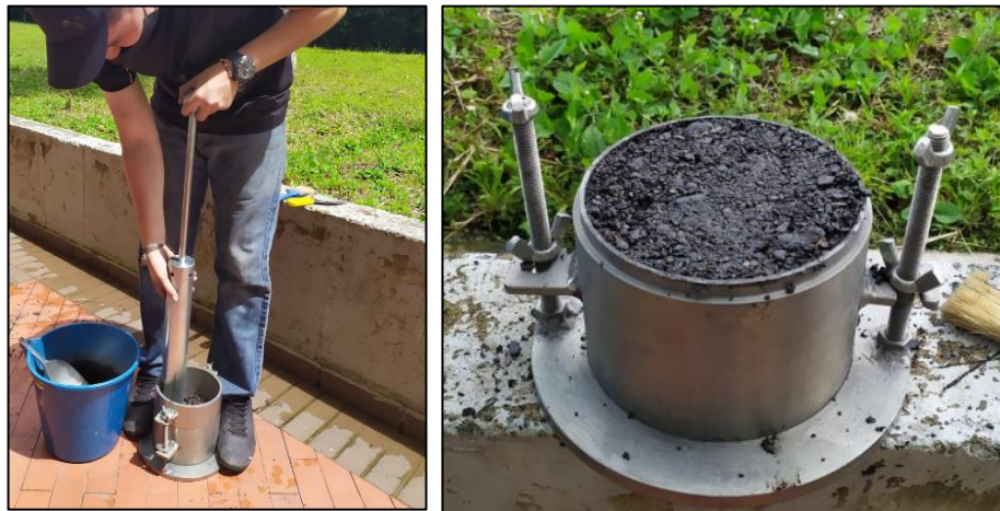
Figura 27. Demostración Proctor Modificado. Fuente: Autor.
