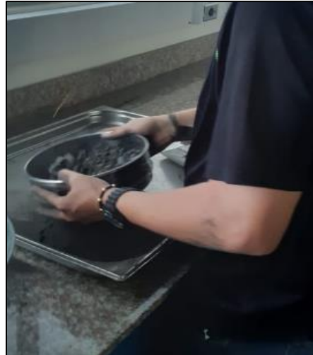
Figura 22. Tamizaje material de desgaste por el tamiz No 12. Fuente: Autor.
