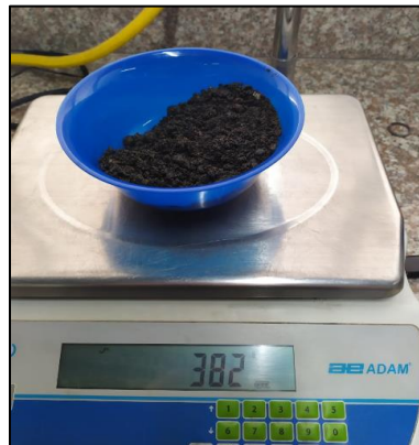
Figura 29. Peso recipiente + material húmedo Fuente: Autor.
