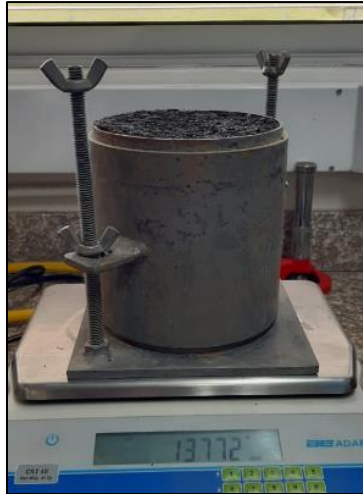
Figura 33. Molde CBR + Material húmedo. Fuente: Autor.
