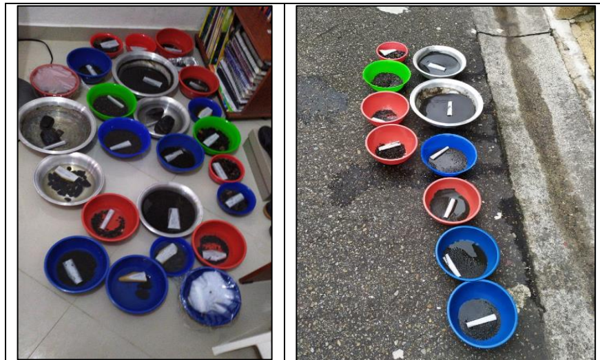
Figura 24. Material sumergido en sulfato de sodio y magnesio Fuente: Autor.
