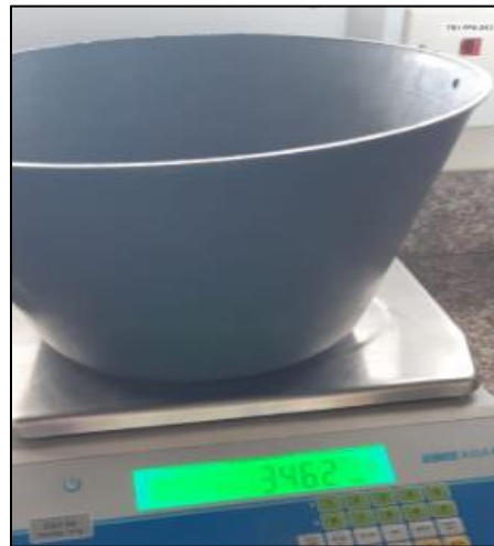
Figura 23. Peso material después del desgaste en la máquina de los ángeles. Fuente: Autor.
