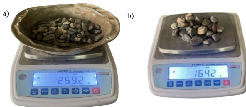
Figura 13. Caras con y sin fracturas en el agregado grueso
