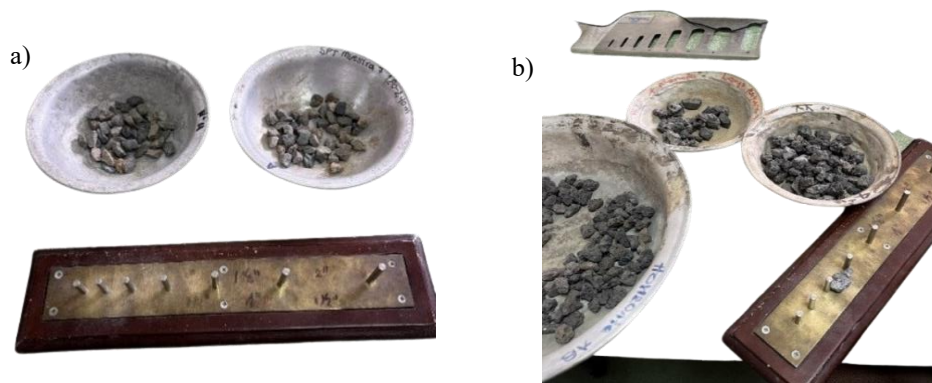
Figura 15. Determinación del índice de alargamiento de una muestra de agregado, escoria
