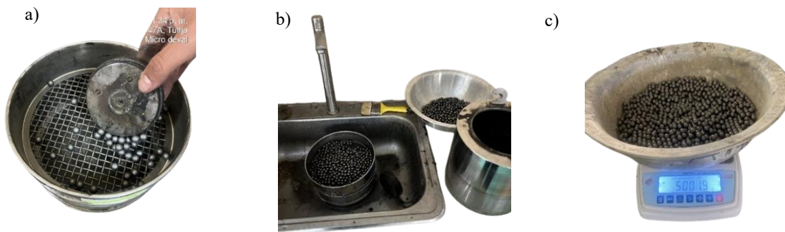
Figura 16. Ensayo con micro-deval para determinar la resistencia de la escoria
