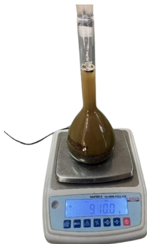
Figura 10. Muestra de arena sumergida en agua para la determinación de la densidad, la densidad aparente y la absorción
