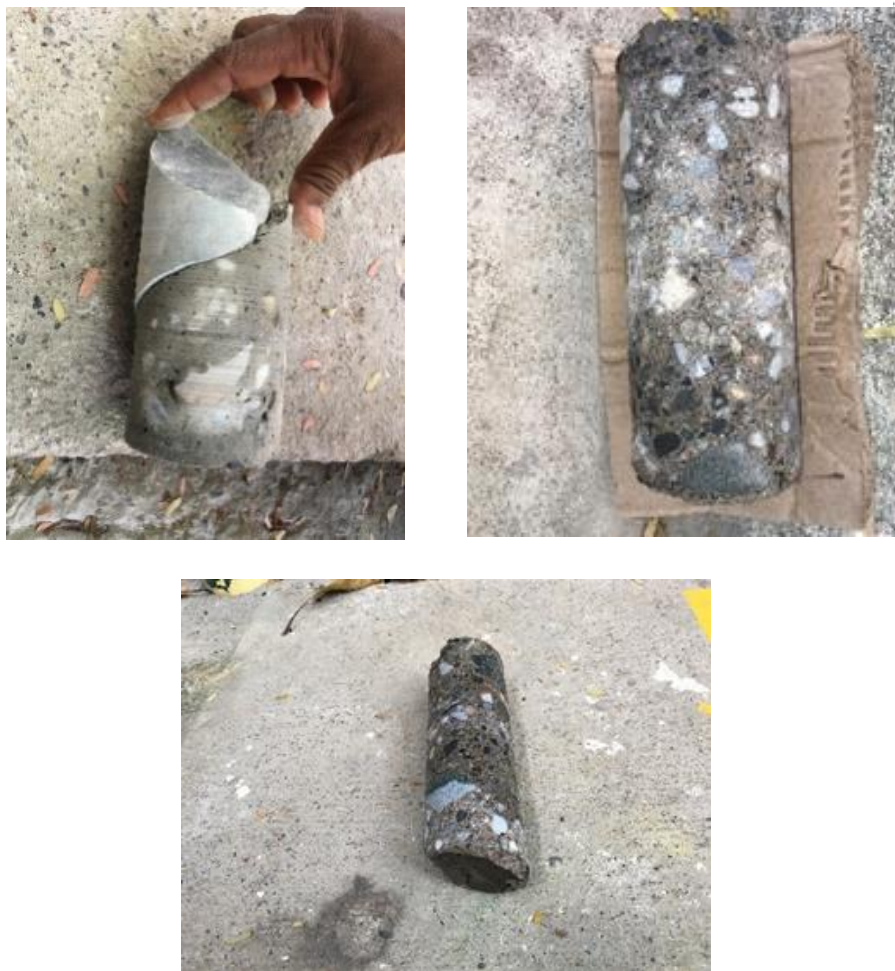
Fuente: Elaboración propia Fecha: 09/03/18 Fotografía 7- Núcleos extraídos (columna, viga y contrafuerte)
