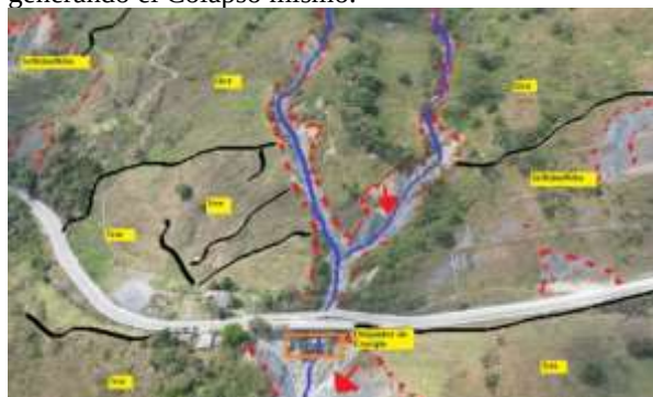
Fotografía 47. SubTramo PR82+300 - PR82+800, (Qcx), depósitos coluviales de diferentes tiempos, Se evidencia socavación y ensanchamiento del canal natural del cuerpo hídrico; (Sr/Rdm/Kilm), suelo residual/ roca degrada y meteorizada de la formación lutitas negras con esporádicas intercalaciones de calizas areniscas.
