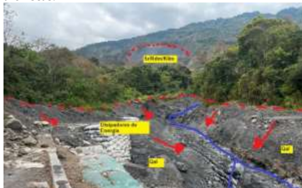
Fotografía 47. SubTramo PR82+300 - PR82+800, (Qcx), depósitos coluviales de diferentes tiempos, Se evidencia socavación y ensanchamiento del canal natural del cuerpo hídrico; (Sr/Rdm/Kilm), suelo residual/ roca degrada y meteorizada de la formación lutitas negras con esporádicas intercalaciones de calizas areniscas.
