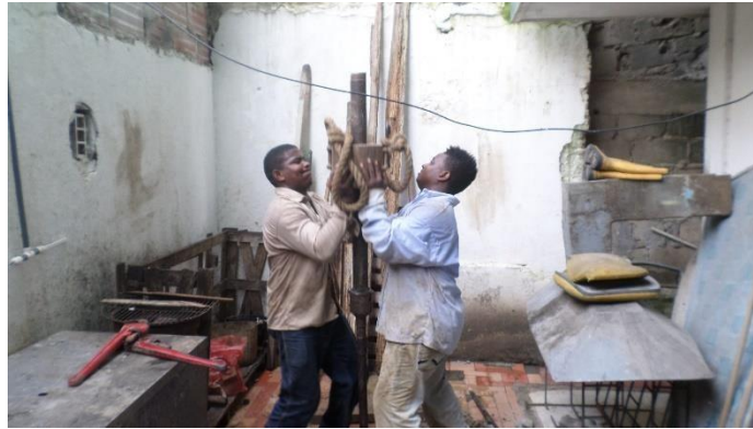
Imagen 1. Perforación con SPT Fuente: Estudio de Suelo
