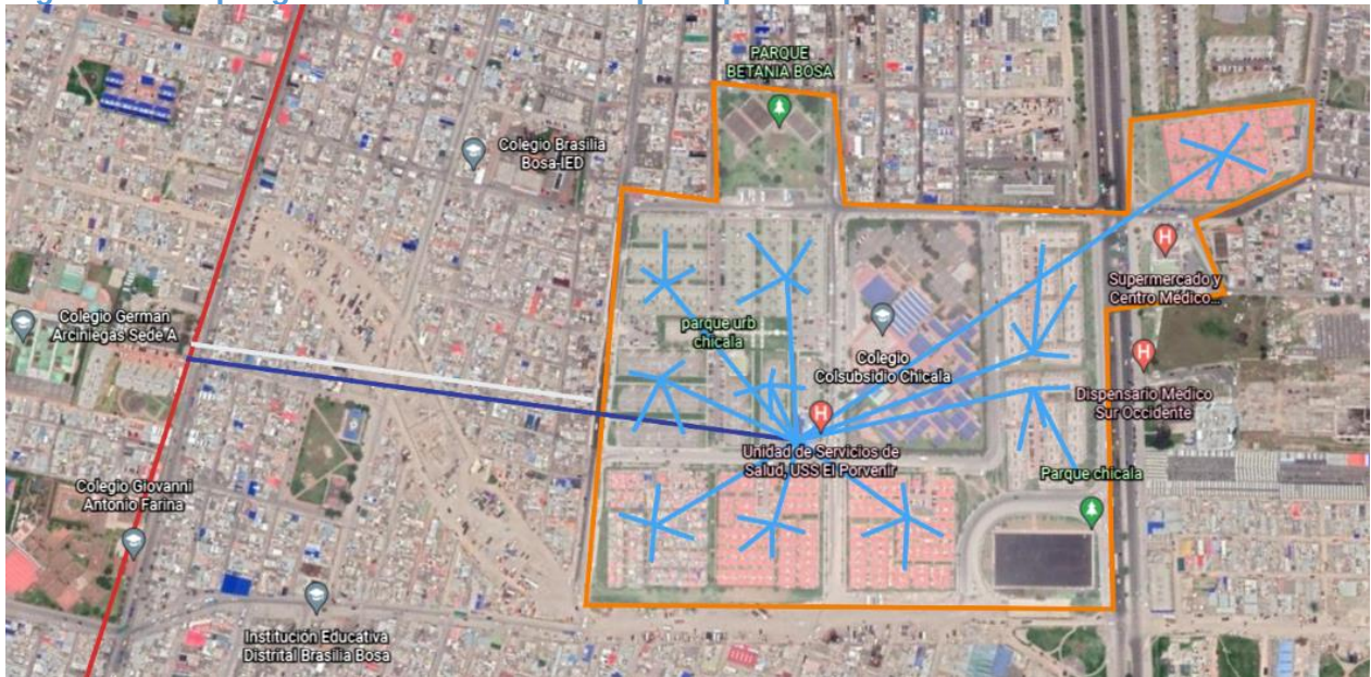
Figura 15 Despliegue solución desde red principal de fibra hasta ONT
