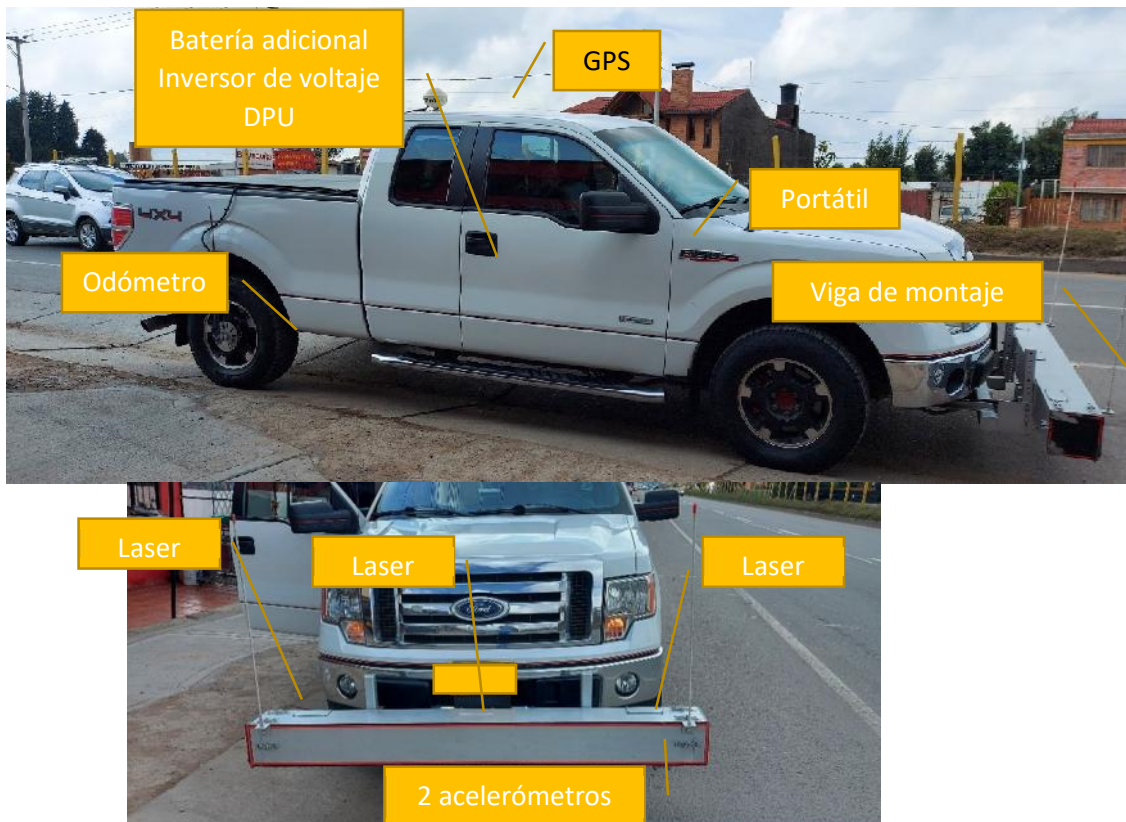
Grafica 41 componentes del perfilómetro laser
