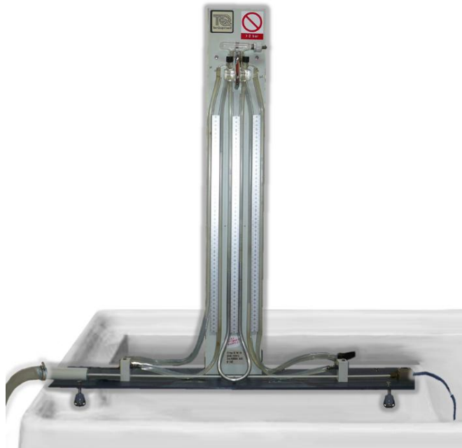
Fig. 1 Aparato para determinar pérdidas por fricción (H7)
