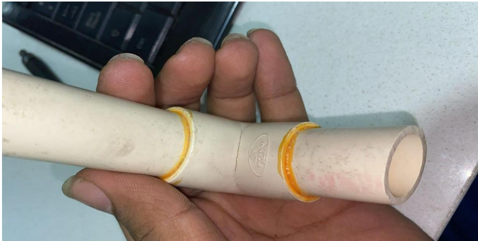
Figura 4. Codo red CPVC fisurado, defecto de fabricación, presión de la red proyecto Central Park II - Bucaramanga
