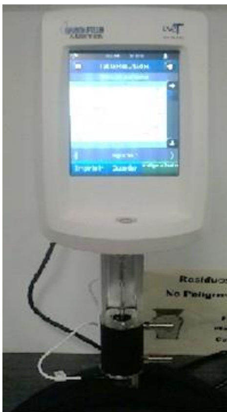
Figure 3.2-5 Viscosímetro Brookfield DV2TLVTJ0 (Laboratorio Ciencias Básicas, Universidad Santo Tomás, Tunja)
