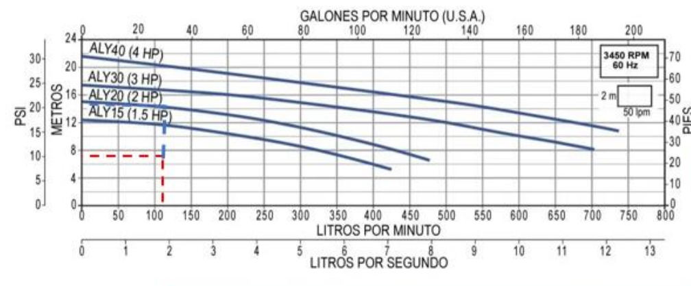
Figura 7. Punto de operación diseño bomba aquapak
