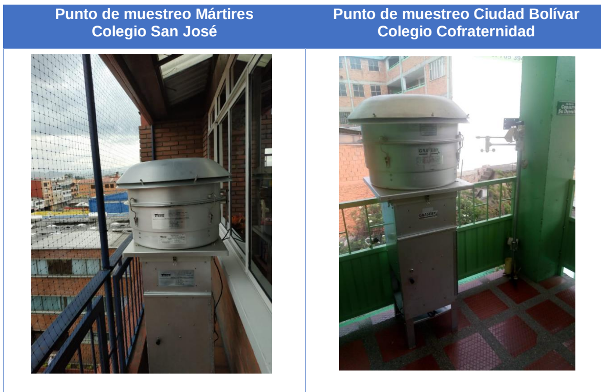
Figura 3-4 Equipos Hi vol en cada punto de muestreo
