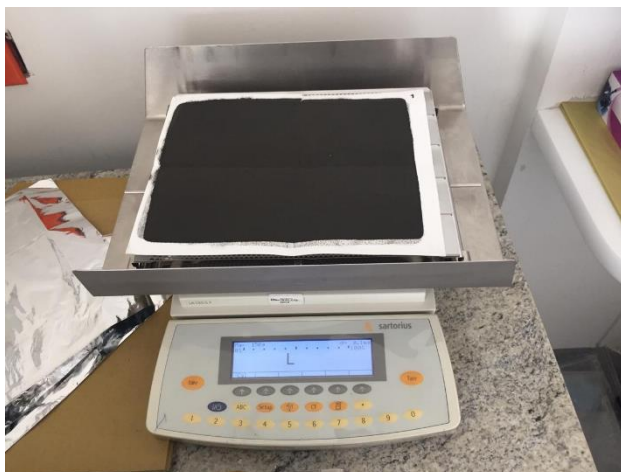
Figura 3-6 Pesaje de filtro impactado en balanza analítica
