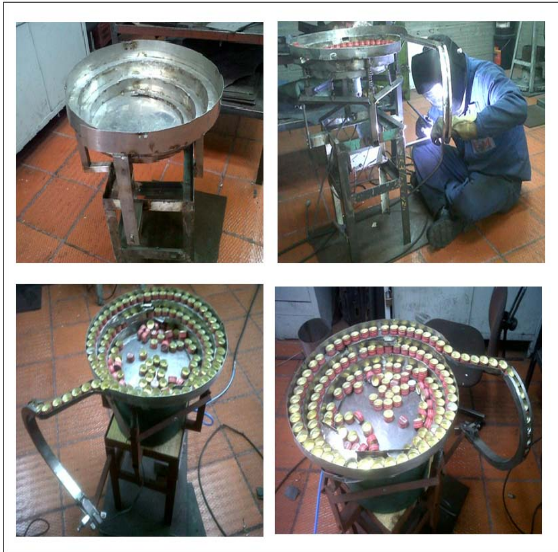
Fig. 13. Fabricación del sistema Bowl Feeder
