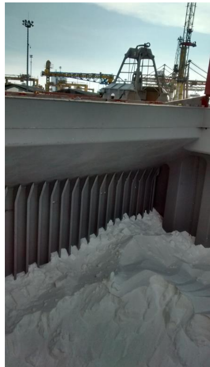
Interior de una de las bodegas del barco granelero – Material Urea G
