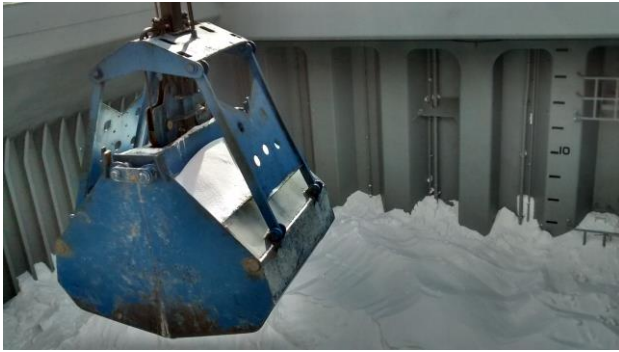
Cuchara descargando Urea del Barco a los vehículos
