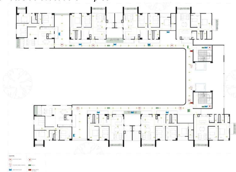
Figura 91. Planta rutas de evacuación 2 piso
