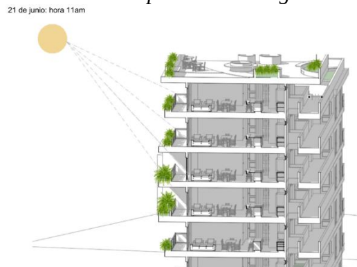
Figura 75. Voladizos en balcones e incorporación de vegetación
