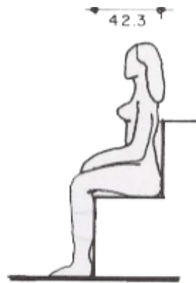
Figuras 12. Profundidad mínima de la superficie del asiento.
