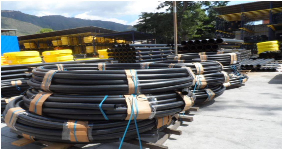
Figura 5 . Línea de Agua (Rollos)
