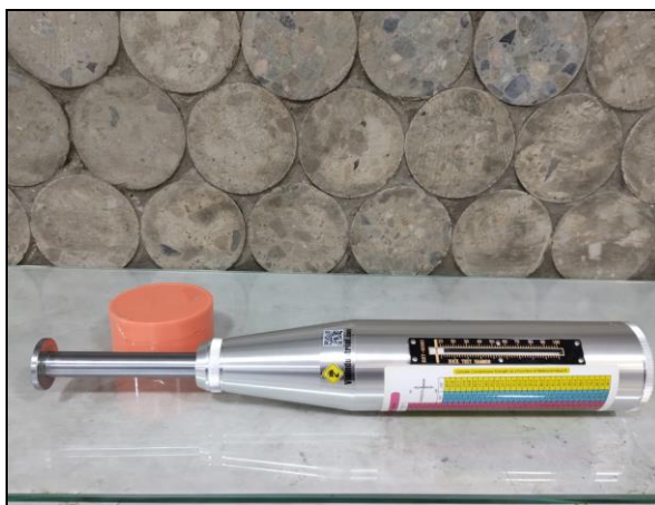
Imagen 1. Equipo esclerómetro para Roca. Fuente propia.
