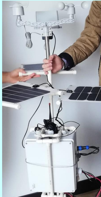
Figura 5. Estación meteorológica fijada en la estructura.
