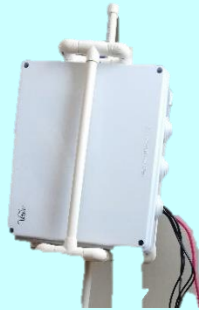
Figura 3. Caja principal de medición.
