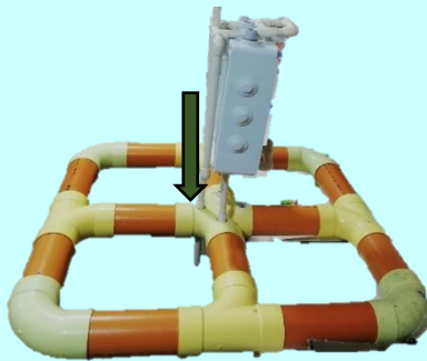
Figura 12. Fijación de la estructura soporte sobre el flotador.
