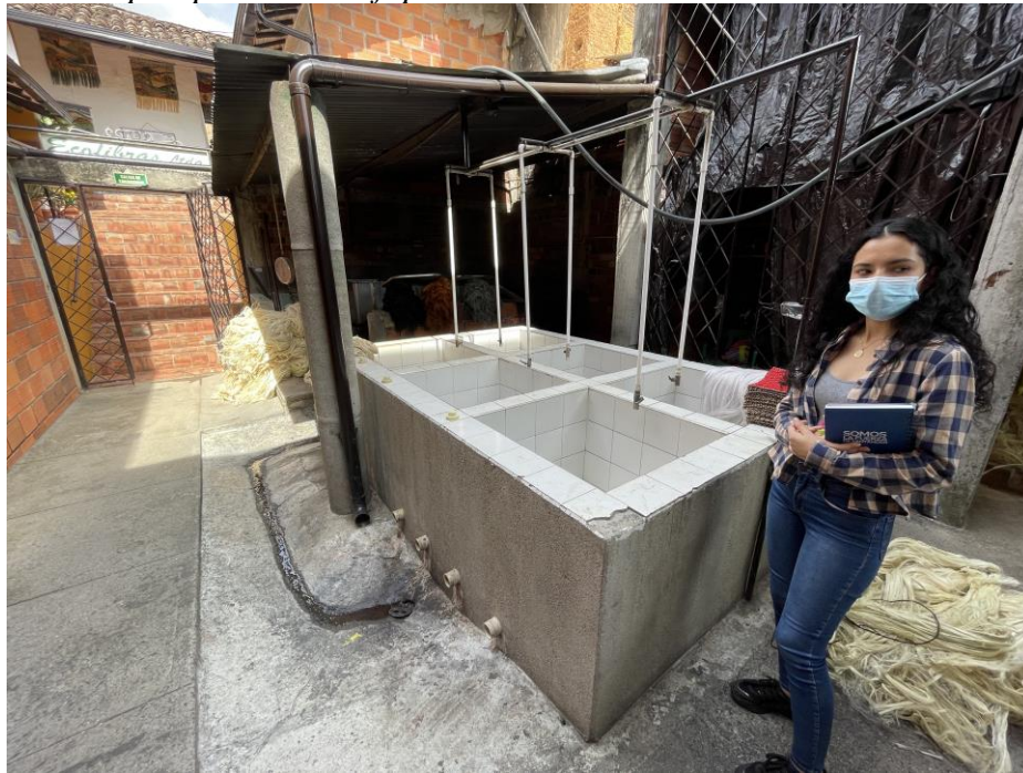
Figura 21. Zona tanques para lavado fique
