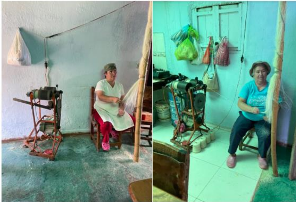
Figura 31. Proceso de hilar fique en el torno
