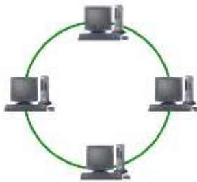
Figura 7. Topología en anillo. “Fuente: http://csudp.wikispaces.com/file/view/Topologias+de+Red.pdf ”
