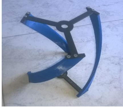
Figura 1. Aerobomba Darrieus De Eje Vertical, por Juan Camilo Romero Gómez, 2018.
