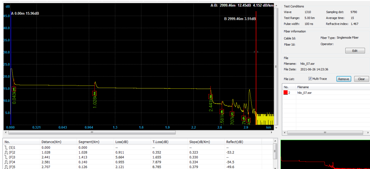
Figura 17. Pantalla OTDR para hilo 7 (Línea 2: L2).
