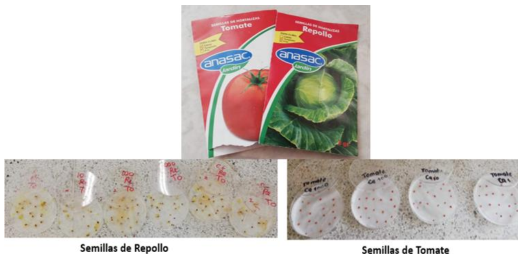
Figura 19. Montaje y semillas empleadas para la determinación de fitotoxicidad de los aceites esenciales de tomillo y cardamomo.
