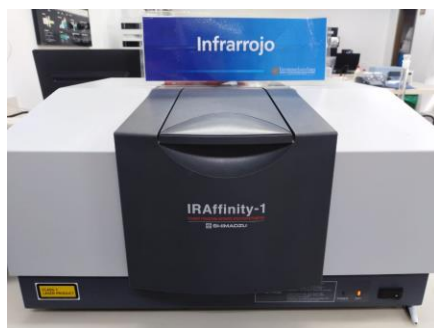
Figura 16. Espectrofotómetro infrarrojo de transformada de Fourier (SHIMADZU), modelo IRAffinity-21.
