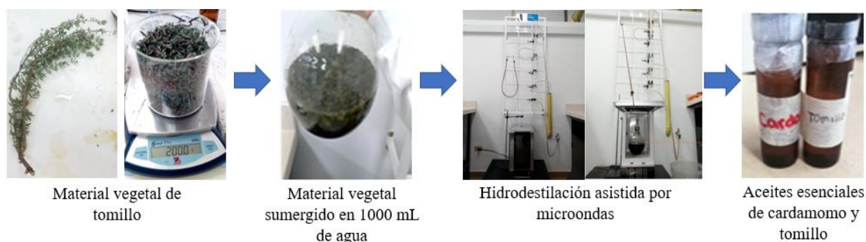
Figura 14. Procedimiento de obtención de AE de tomillo y cardamomo empleado el método de hidrodestilación asistida por microondas.
