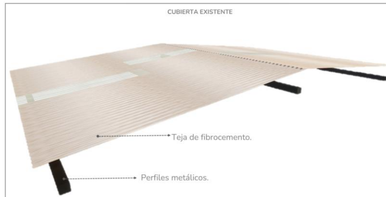
Figura 99. Materialidad existente en cubierta.
