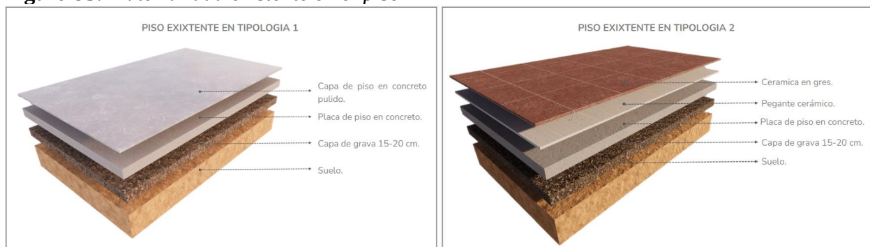
Figura 95. Materialidad existente en el piso
