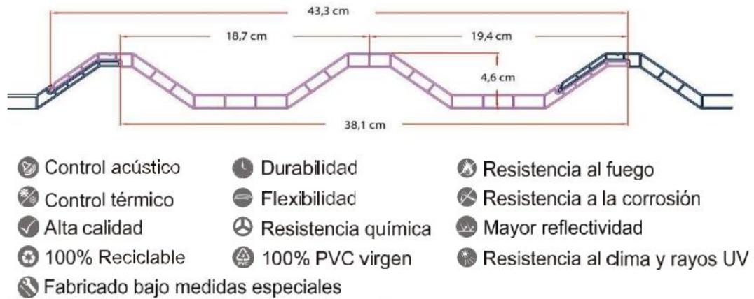
Figura 101. Características generales teja Azembla.
