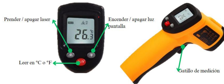
Figura 3. Funcionamiento termómetro laser
