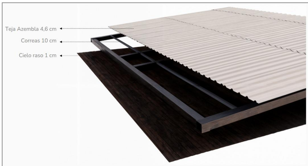
Figura 102. Materialidad propuesta en cubierta con teja Azembla.
