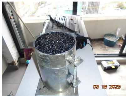
Figura 21. Montaje de asfalto sobre base granular compacta
