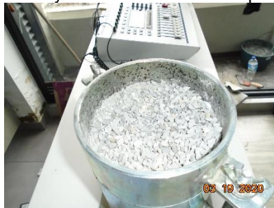
Figura 35. Ensayo acústico mezcla con piedra pómez
