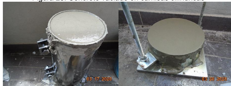
Figura 25. Concreto vaciado en camisas cilíndricas
