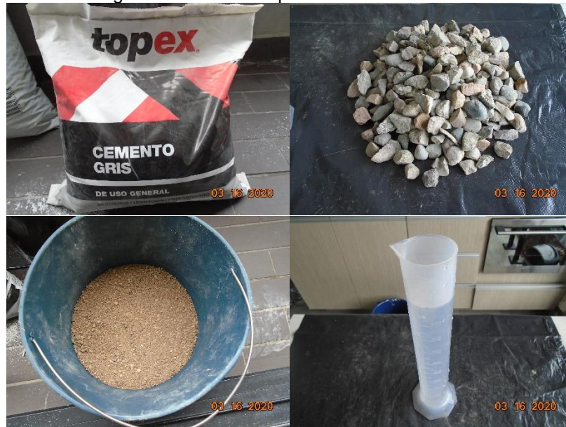
Figura 24. Materiales para mezcla de concreto
