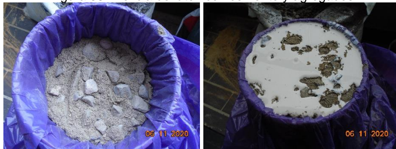
Figura 38. Mezcla de látex con cemento y agregados
