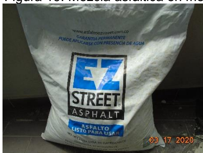
Figura 19. Mezcla asfáltica en frío
