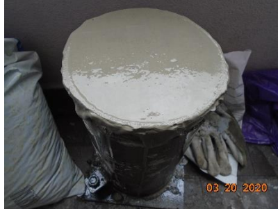
Figura 36. Mezcla de concreto a base de piedra pómez
