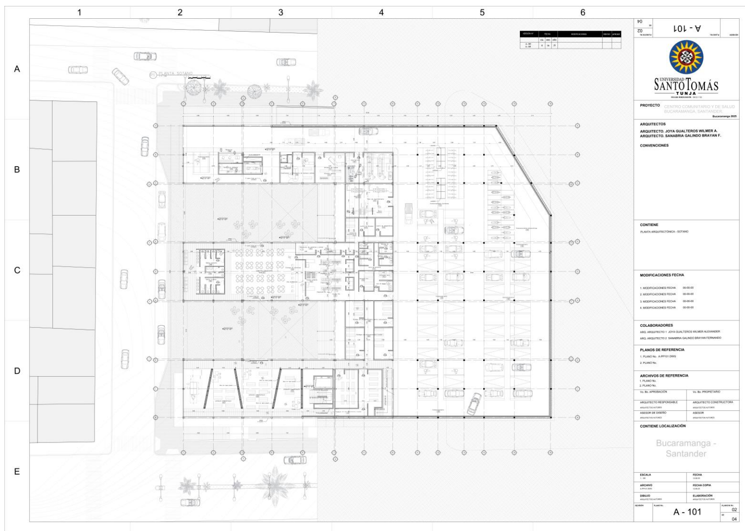
Anexo 2. Planta arquitectónica – Sótanos. Fuente: Elaboración propia.
