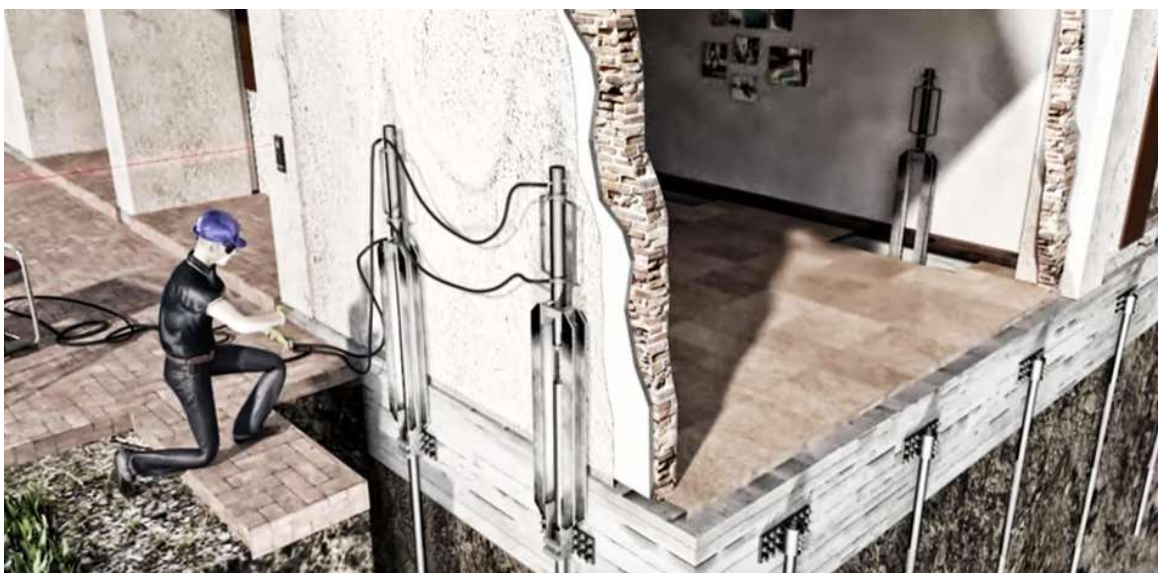
Ilustración 40. Micropilotes. Fuente: https://www.geosec.es/cimentaciones-especiales/
