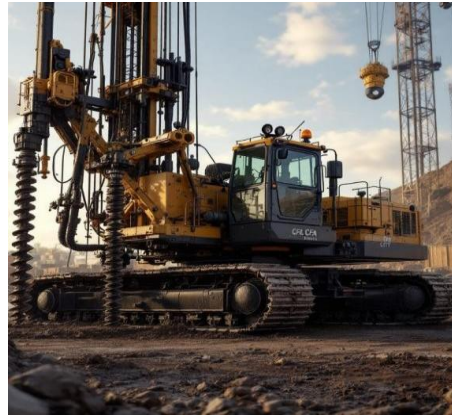
Figura 50. Máquina de pilotes CFA moderna
