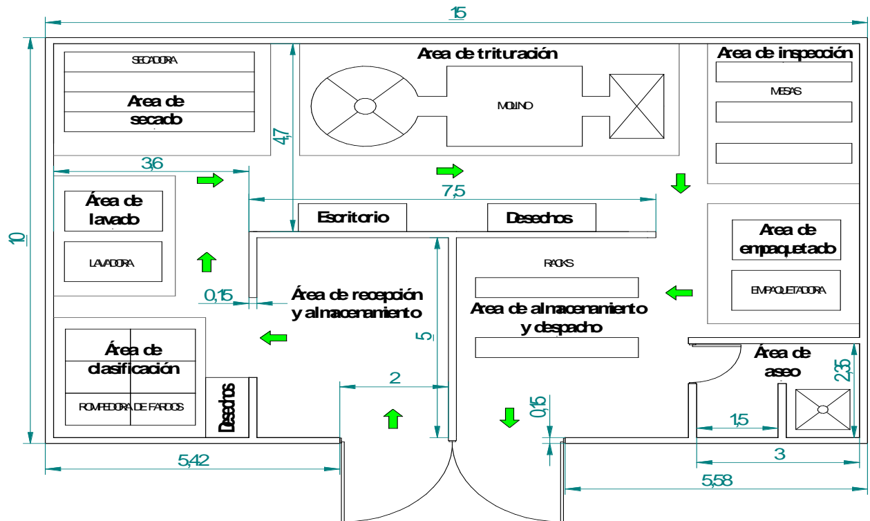
Ilustración 6 Distribución en planta
