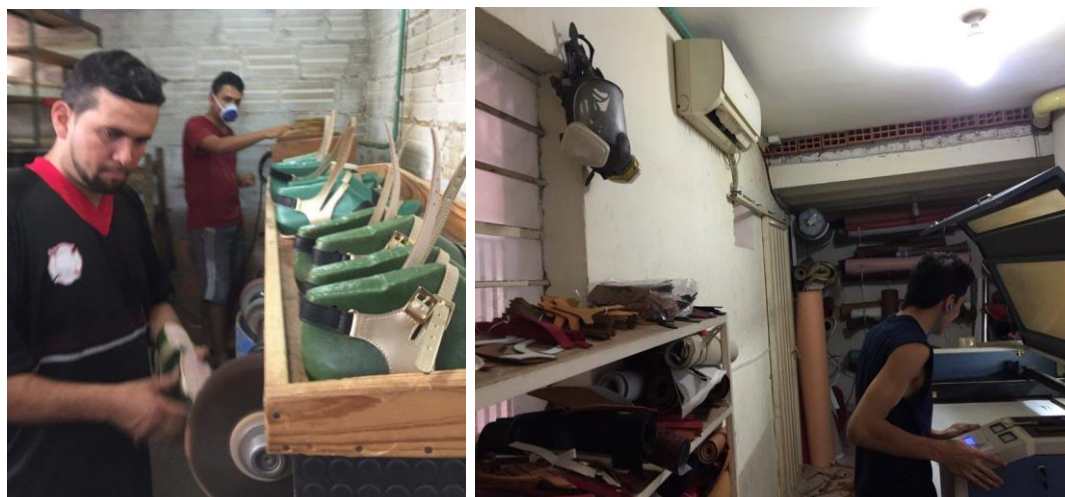
Figura 5. Evidencia del no uso de los elementos de protección personal.
