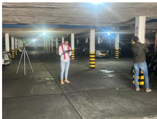
Figura 13. Toma de deflexiones con nivel laser
