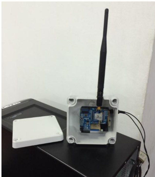
Figura 51. Pruebas de funcionamiento Nodo Coordinador
