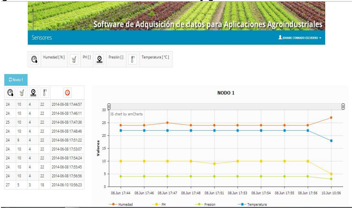
Figura 54.Pruebas de funcionamiento tabla y gráfica del Nodo 1
