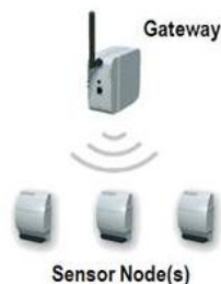
Figura 1. Componentes de WSN Gateway y Nodos Distribuidos
