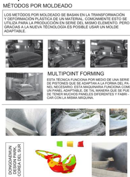
Figura 71. Métodos de fabricación por moldeado
