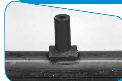
FALTA DE CALENTAMIENTO
