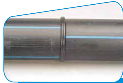
DEMASIADA PRESIÓN Y TEMPERATURA REBORDE MUY GRUESO
