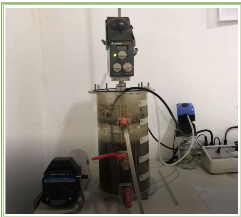
Figura 6. Montaje experimental del sistema aerobio empleado en la experimentación.
