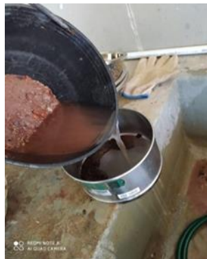
Figura 38. Lavado de la muestra para Granulometría
