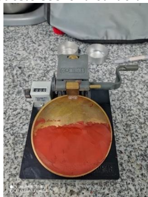
Figura 51. Suelo humedecido y dispuesto sobre la cazuela
