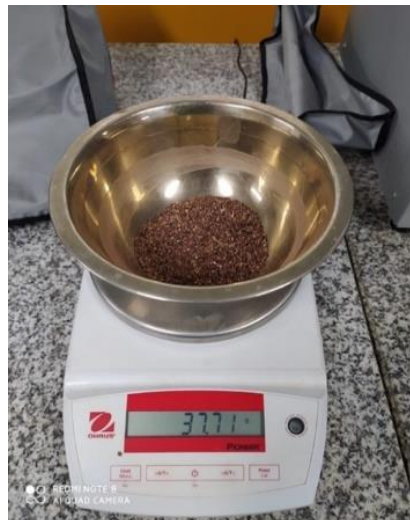
Figura 42. Registro de pesos retenidos en cada tamiz
