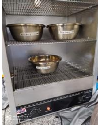
Figura 39. Muestras lavadas listas para secado
