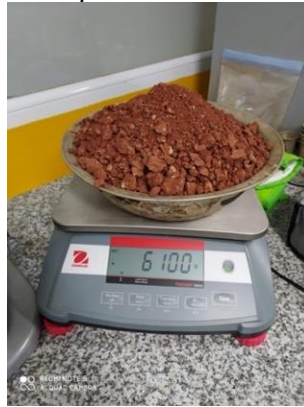
Figura 63. Muestra utilizada para la compactación de cada espécimen
