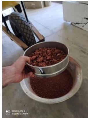
Figura 74. Tamizado del material por el tamiz No. 4
