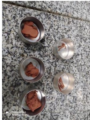
Figura 54. Muestras secas después de estar 12h en el horno
