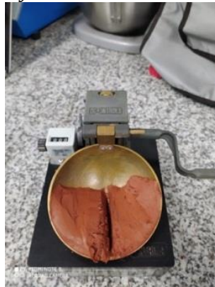
Figura 52. Muestra de suelo húmeda y ranurada
