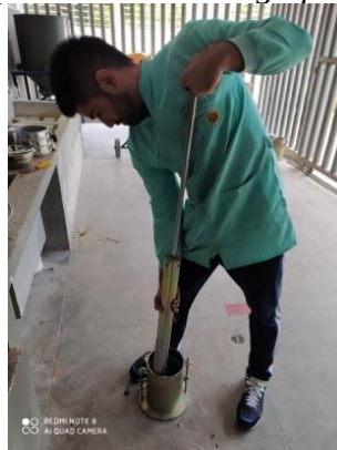
Figura 67. Compactación de los especímenes con 56 golpes por capa
