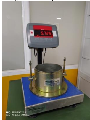
Figura 65. Registro del peso del molde y la base para cálculos
