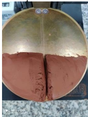
Figura 53. Unión de los taludes formados por el ranurador a una longitud de 13mm
