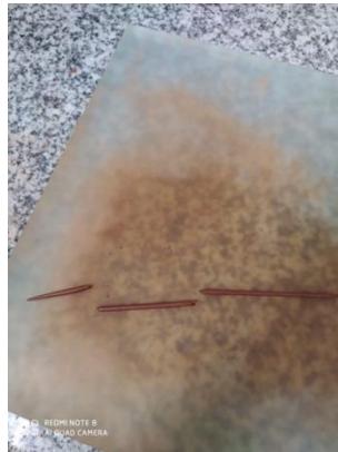
Figura 58. Agrietamiento y rompimiento de los rollos de suelo
