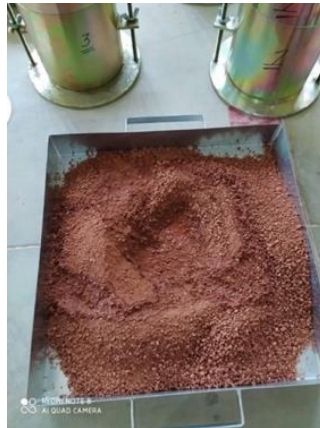
Figura 76. Material con humedad del 14.%
