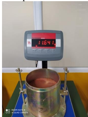
Figura 79. Masa del molde invertido compactado sin disco espaciador.
