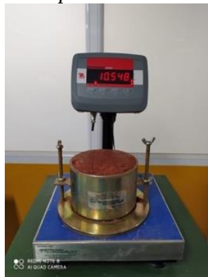
Figura 66. Peso molde enrasado con el espécimen
