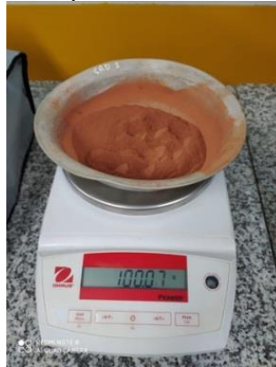
Figura 50. Medición de 100g de muestra para realizar el ensayo
