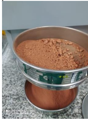
Figura 49. Tamizado de la muestra por el No. 40
