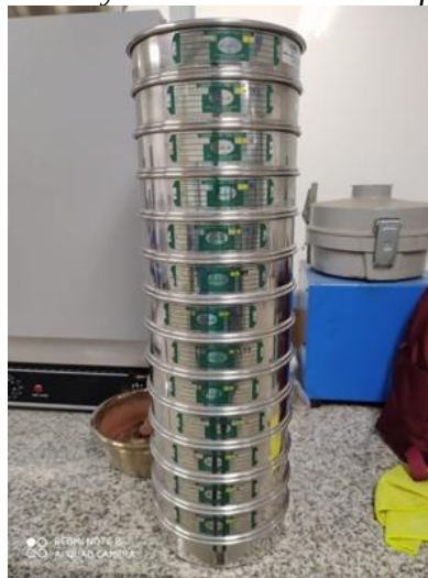
Figura 41. Tamices organizados de mayor a menor diámetro para vibración manual
