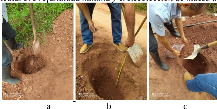
Figura 33. a. Calicata. b. Profundidad mínima y c. Recolección de muestra
