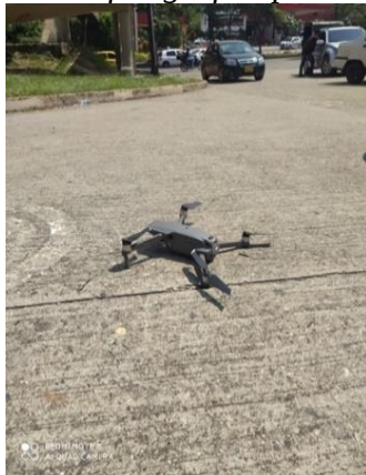
Figura 23. Dron encargado de captar las fotografías para obtener la topografía superficial
