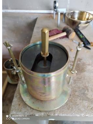
Figura 80. Molde con el vástago y las cargas
