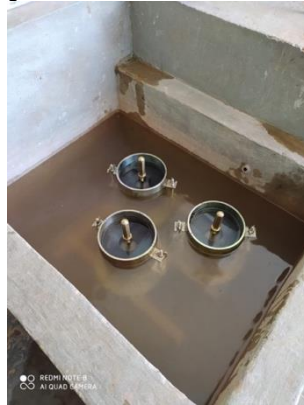
Figura 82. Inmersión de los moldes por 96 horas
