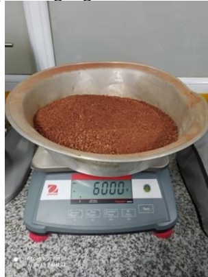
Figura 75. Material pesado y listo para agregar la humedad óptima
