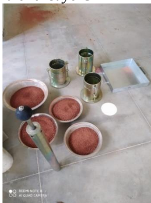
Figura 72. Materiales utilizados para el ensayo CBR
